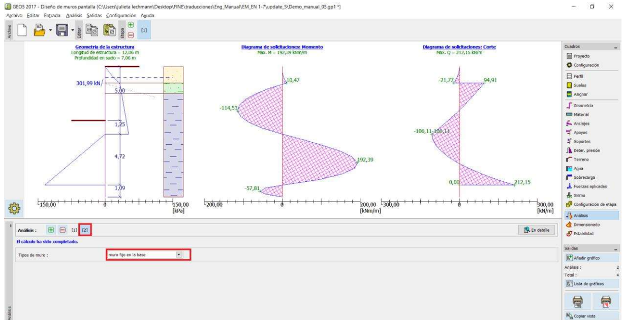
Cuadro "Análisis" – etapa de construcción 2 (Muro fijo en la base)
