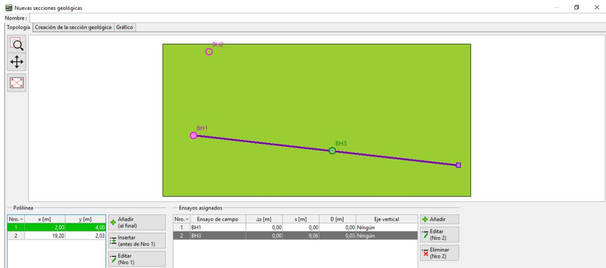
Después de la entrada, la sección transversal se corta en las dimensiones del sitio de construcción y se abre en la ventana de diálogo para editar - en la pestaña "Topología". Aquí, asignamos los ensayos que queremos mostrar en la sección transversal.
